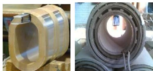
شکل (۱) مقطع ترانسفورماتور (الف) سیلندری، (ب) اول
