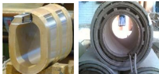
شکل (۱) مقطع ترانسفورماتور (الف) سیلندری، (ب) اوال
