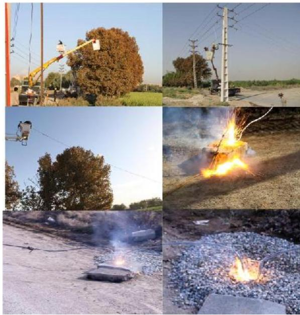
شکل (۱۳): ساختار فیزیکی آزمایش خطای امپدانس بالا
