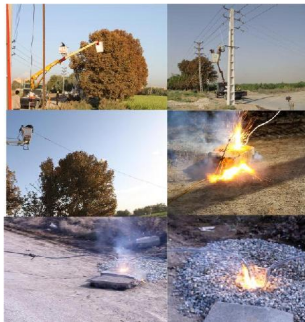
شکل (۱۳): ساختار فیزیکی آزمایش خطای امیدانس بالا
