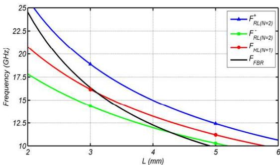
شکل (۸): نمودار فرکانس‌های تشدید و فرکانس بهترین نسبت جلو به عقب بر حسب طول بلوک‌های تشکیل دهنده‌ی ساختار انتقالی؛ ابعاد و مشخصات ساختار:  $\epsilon_{\text{eff}} = 4.23, s = 0.2 \text{ mm}, h = 2.16 \text{ mm}$
