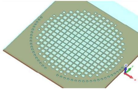
شکل (۵): لنز لونیبرگ طراحی شده با استفاده از نمودارهای شکل (۴) و رابطه‌ی (۷)؛ ساختار لنز بین دولاچه دی الکتریک چاپ شده است. در شکل بالا، تنها زیرلایه‌ی پایین (RO3010) و لنز روی آن نشان داده شده است.
