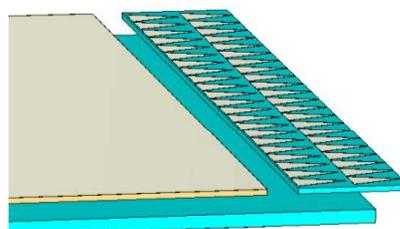
شکل (۹): نمایش ساختار انتقالی آنتن برای تطبیق دهانه با امپدانس فضای آزاد؛ به منظور ایجاد تقارن در بخش تشعشع آنتن، یک تکه زیرلایه‌ی RO 4003 با ضخامت  $h=25$  mil در بخش ساختار انتقالی، به جای امتداد زیر لایه‌ی RO 3010 استفاده شده است.
