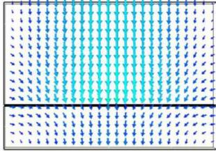
شکل (۶): نمایش میدان‌های الکتریکی مربوط به مد اول انتشاری در ساختار شکل (۳) در صفحه‌ی  $\psi=0$ ؛ میدان‌های الکتریکی در هر دولاچه هم‌فاز هستند و بنابراین تغذیه‌ی مناسب برای تحریک این مد می‌تواند از نوع کابل هم‌محور و یا خط ریزنوار باشد.
