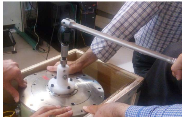
شکل (۱۰): اندازه‌گیری گشتاور تولیدی موتور در جریان نامی
