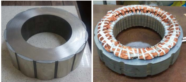
شکل (۷): استاتور و رتور ساخته‌شده
