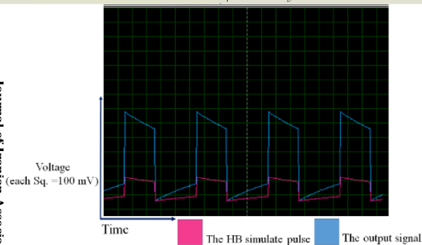
شکل (۶): راه‌اندازی حس گر فشارخون با استفاده از فناوری میکرو الکترومکانیکی و مدارات ابزار دقیق
