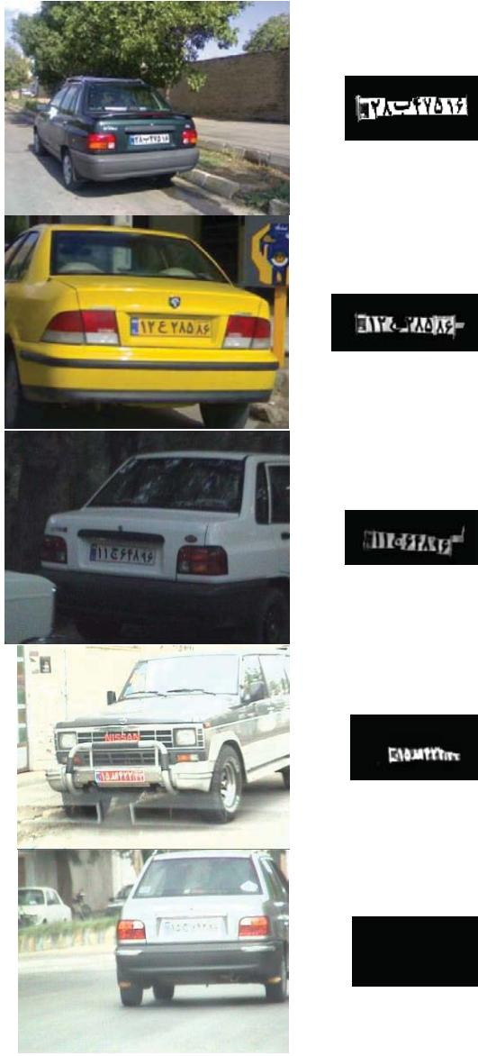
شکل (۸): تعدادی از نتایج آشکارسازی محل پلاک خودرو با استفاده از روش پیشنهادی
