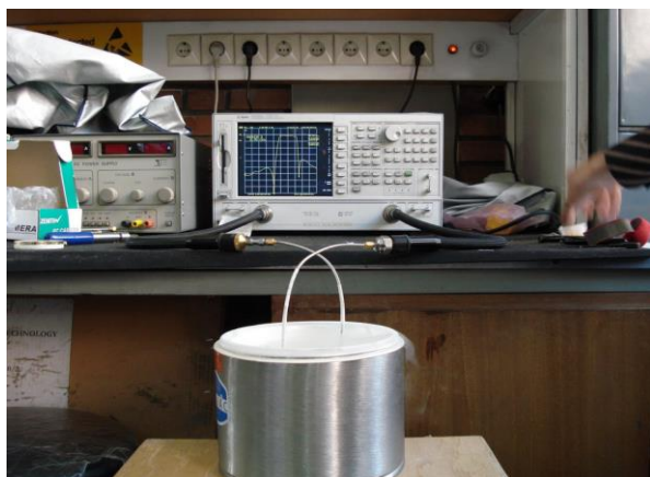
شکل (۹): سیستم اندازه گیری مشخصات فیلتر ابررسانا
