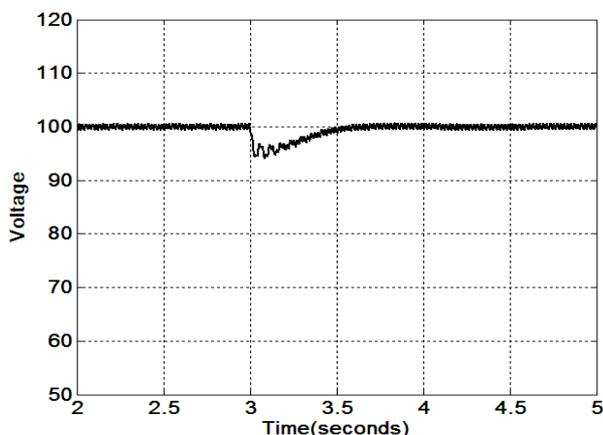
شکل (۱۴): رفتار دینامیکی ولتاژ خروجی در حین افزایش ولتاژ ورودی از ۱۲۰ ولت به ۱۵۰ ولت
