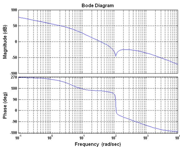
شکل (۱۰): دیاگرام بد تابع انتقال حلقه ولتاژ
