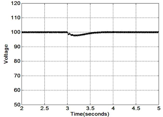
شکل (۱۵): رفتار دینامیکی ولتاژ خروجی در حین تغییر پله ای بار کامل به نصف بار کامل
