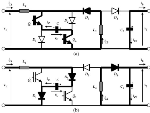
شکل (۴): مراحل عملکرد مبدل ارتقاء یافته شپارد- تیلور در حالت جریان پیوسته در سلفها و ولتاژ پیوسته در خازن میانی (a) هنگامی که سوئیچهای  $Q_1$  و  $Q_2$  روشن می باشند (b) هنگامی که سوئیچهای  $Q_1$  و  $Q_2$  خاموش می باشند [۱۱].
