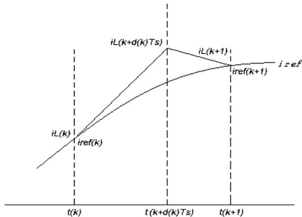
شکل (۵): شکل موج جریان ورودی و جریان مرجع در طول یک مرحله کلید زنی
