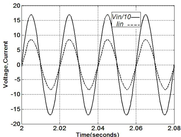
شکل (۱۲): جریان و ولتاژ ورودی شپارد- تیلور در حالت پایدار (بار کامل)
