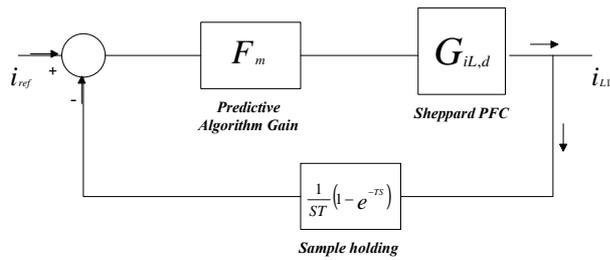
شکل (۹): بلوک دیاگرام سیستم حلقه بسته جریان
