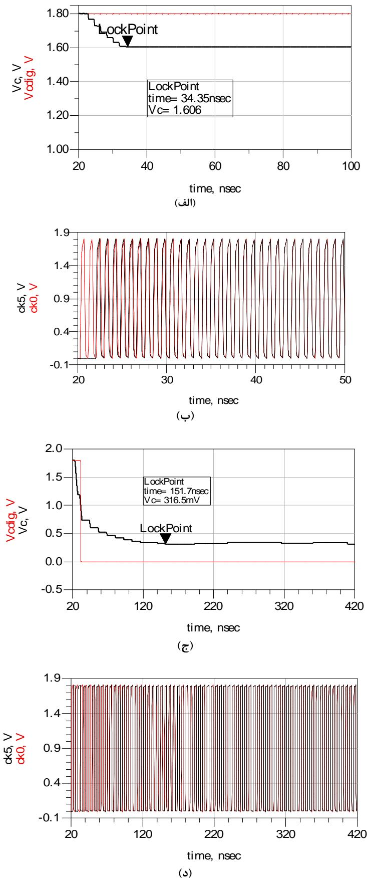
شکل(۶): (الف) شکل موج های ورودی و خروجی و (ب) تغییر ولتاژ کنترلی در فرکانس ۱۱۰۰MHz (ج) شکل موج های ورودی و خروجی و (د) تغییر ولتاژ کنترلی در فرکانس ۱۷۰MHz
