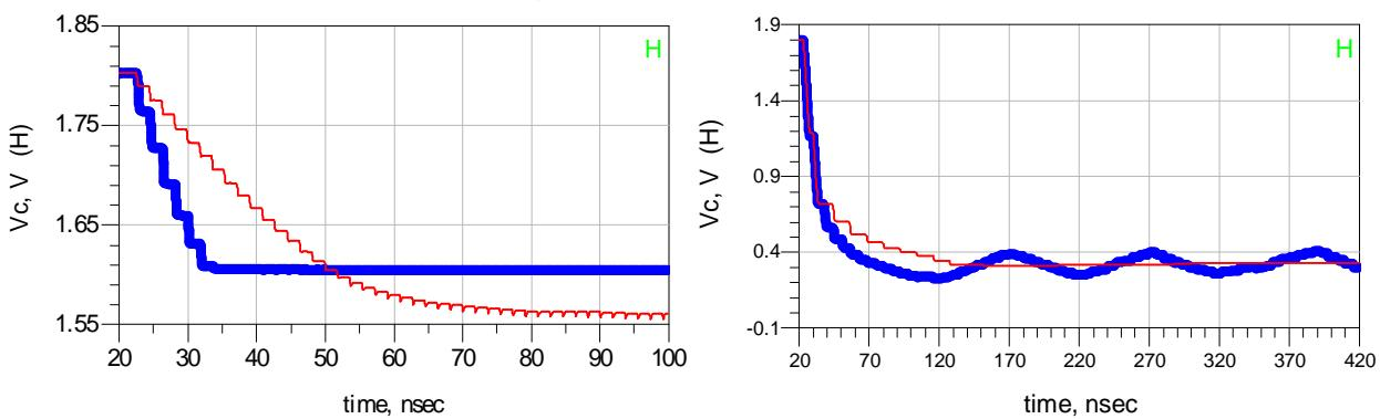
شکل (۱۰): مقایسه روند قفل حلقه با CP ساده و نمونه پیشنهادی در فرکانس (الف) ۱۱۰MHz و (ب) ۱۷۰MHz
