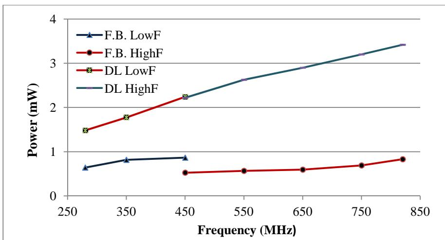
شکل (۱۲): نمودار توان مصرفی مجذا شده برای خط تأخیر و حلقة فیدبک در فرکانس های مختلف
