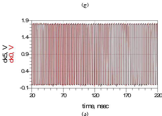
شکل(۱۳): (الف) شکل موج های ورودی و خروجی و (ب) تغییر ولتاژ کنترلی در فرکانس ۸۲۰MHz از تکنولوژی کند (ج) شکل موج های ورودی و خروجی و (د) تغییر ولتاژ کنترلی در فرکانس ۲۸۰MHz از تکنولوژی سریع
