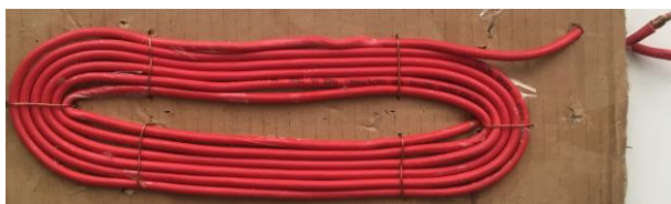
شکل (۷): شکل سیم‌پیچ مورد استفاده در مدار گرمایش القایی
