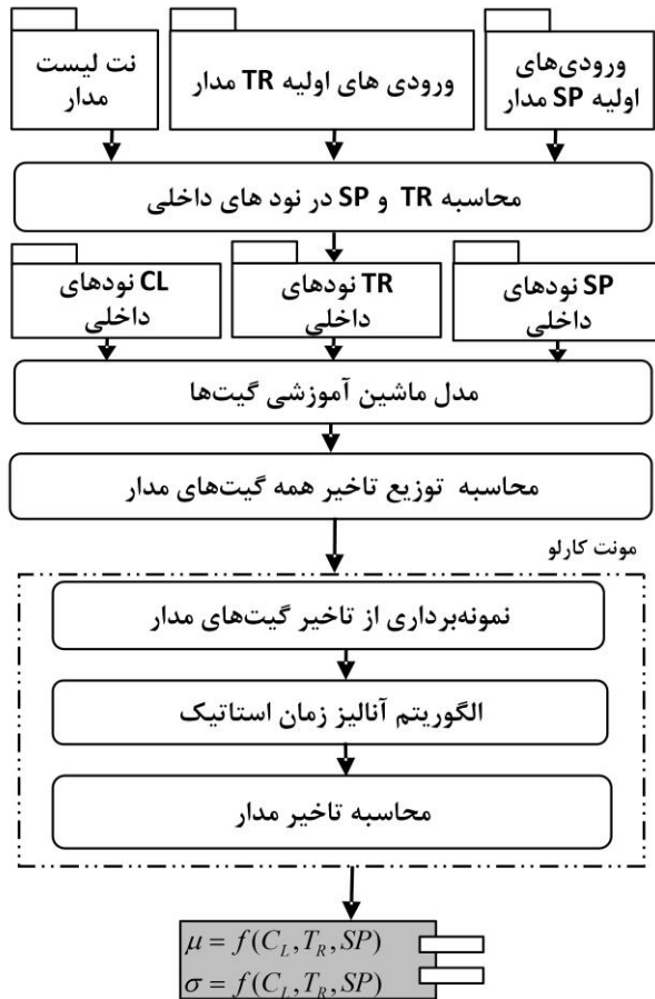
شکل (۴): فرایند محاسبه مدل تأخیر مدار دیجیتال
