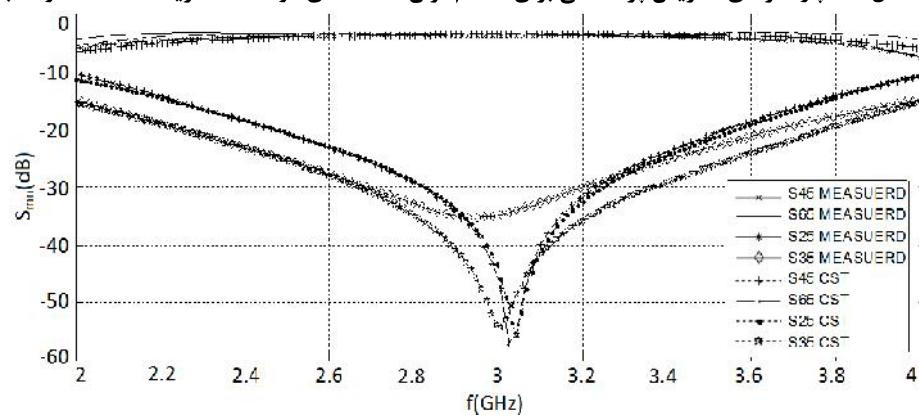
شکل(۱۲): پارامترهای ماتریس پراکندگی برای مقسم توان ۶ دهانه ای در حالت تحریک دهانه (۵) و نسبت توان ۱:۱
