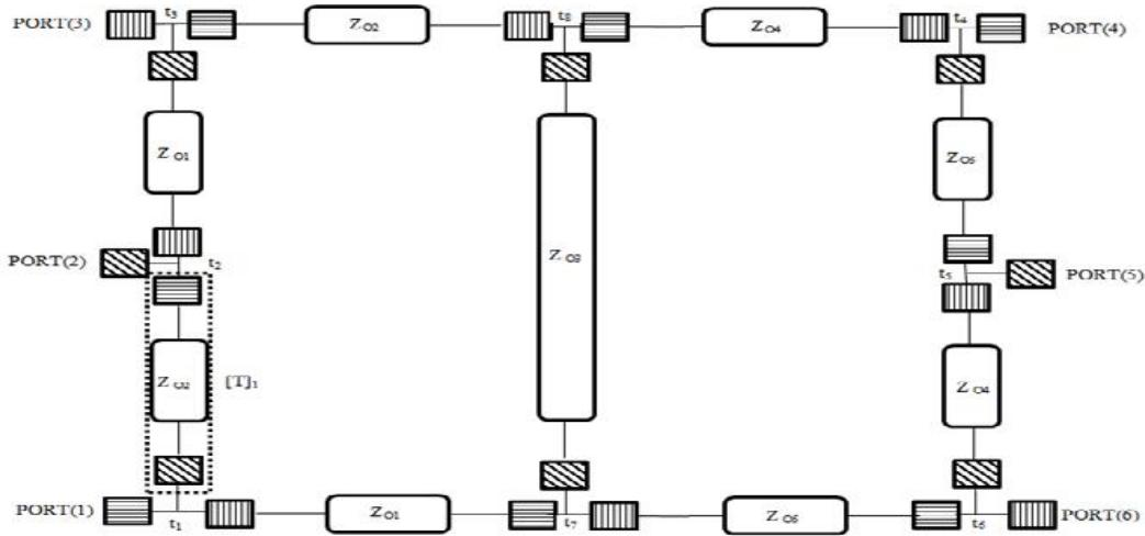
شکل (۳): تجزیه مقسم توان ۶ دهانه ای
