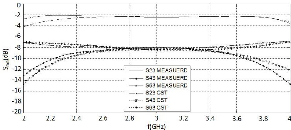
شکل(۱۰): پارامترهای ماتریس پراکندگی برای مقسم توان ۶ دهانه ای در حالت تحریک دهانه (۳) و نسبت توان ۴:۱:۱
