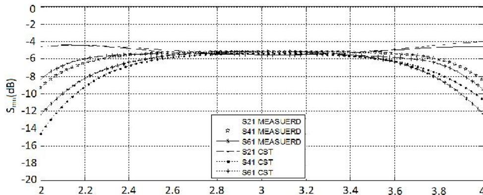
شکل(۷): پارامترهای ماتریس پراکندگی برای مقسم توان ۶ دهانه ای در حالت تحریک دهانه (۱) و نسبت توان ۱:۱:۱:۱
