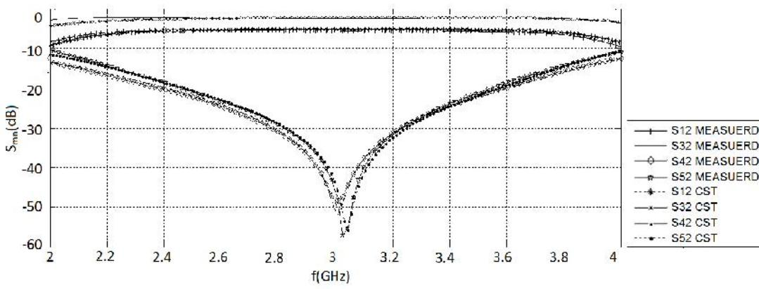
شکل(۹): پارامترهای ماتریس پراکندگی برای مقسم توان ۶ دهانه ای در حالت تحریک دهانه (۲) و نسبت توان ۱:۲
