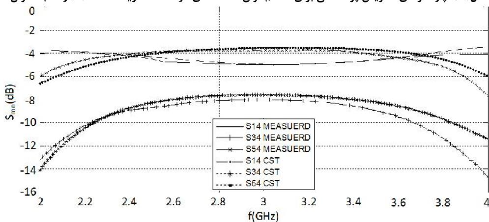
شکل(۱۱): پارامترهای ماتریس پراکندگی برای مقسم توان ۶ دهانه ای در حالت تحریک دهانه (۴) و نسبت توان ۳:۲:۱
