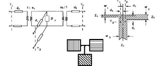
شکل (۲): اتصال T شکل نا متقابن و مدار معادل مربوط [۱۰]
