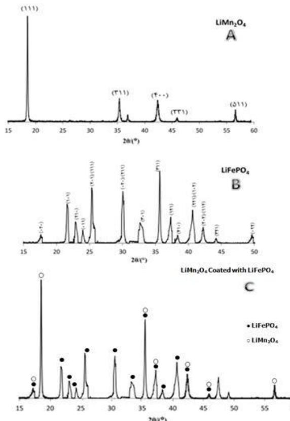
شکل (۱): الگوی پراش اشعه ایکس محصولات سنتز شده (A):  $\text{LiMn}_2\text{O}_4$  بدون پوشش (B):  $\text{LiMn}_2\text{O}_4$  پوشش داده شده با  $\text{LiFePO}_4$
