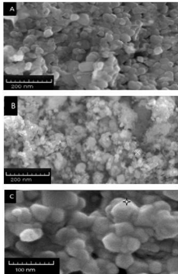
شکل (۲): تصاویر SEM (C) و LiMn<sub>2</sub>O<sub>4</sub> (A) و LiMn<sub>2</sub>O<sub>4</sub> (B) پوشش داده شده با  $\text{LiFePO}_4$
