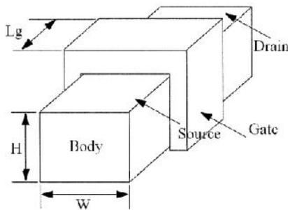
شکل (۲): ساختار یک افزاره MOSFET سه گیتی
