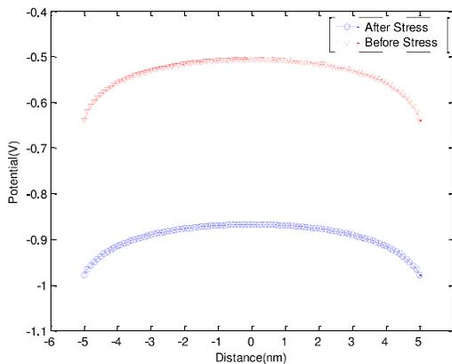
شکل (۱۵): مقایسه توزیع پتانسیل در بدنه بعد از گذشت ۱۰۰۰ ثانیه از شروع اعمال تنش NBTI با توزیع پتانسیل پیش از اعمال تنش
