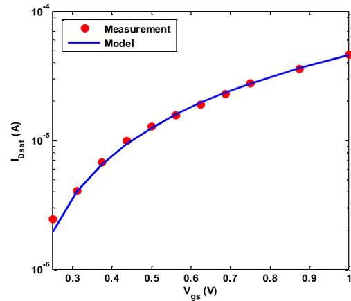
شکل (۹): مشخصه جریان درین به ولتاژ گیت برای افزاره FinFET
