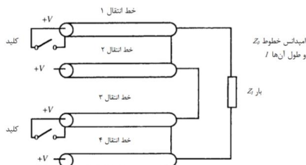
شکل (۱): ترسیم ساده‌ای از خط شکل‌دهی پالس BPF دو حالتی
