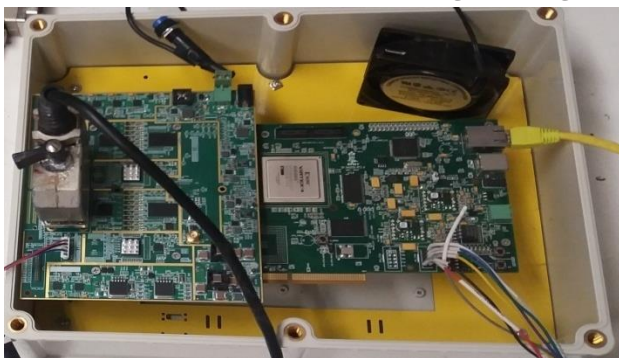
شکل (۱۶): برد سخت افزار طراحی شده برای آزمون فراصوتی
