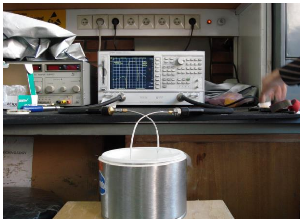
شکل (۹): سیستم اندازه گیری مشخصات فیلتر ابررسانا
