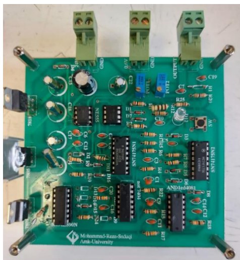
شکل (۷): سیستم تشخیص و قطع چراغ LED روشنایی معابر در حالت سسکسه زدن
