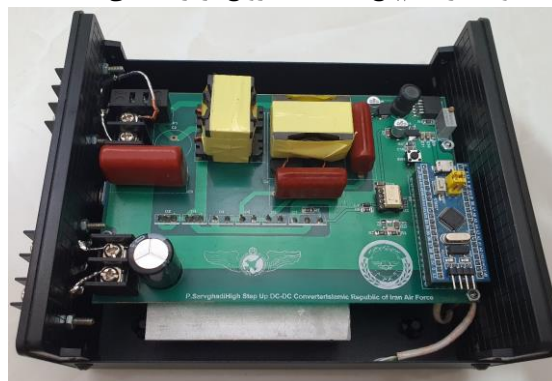
شکل (۶): نمونه آزمایشگاهی مبدل DC-DC پیشنهادی
