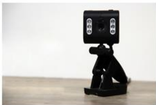
شکل (۲): دوربین مورد استفاده جهت اندازه‌گیری جابجایی میز لرزه
