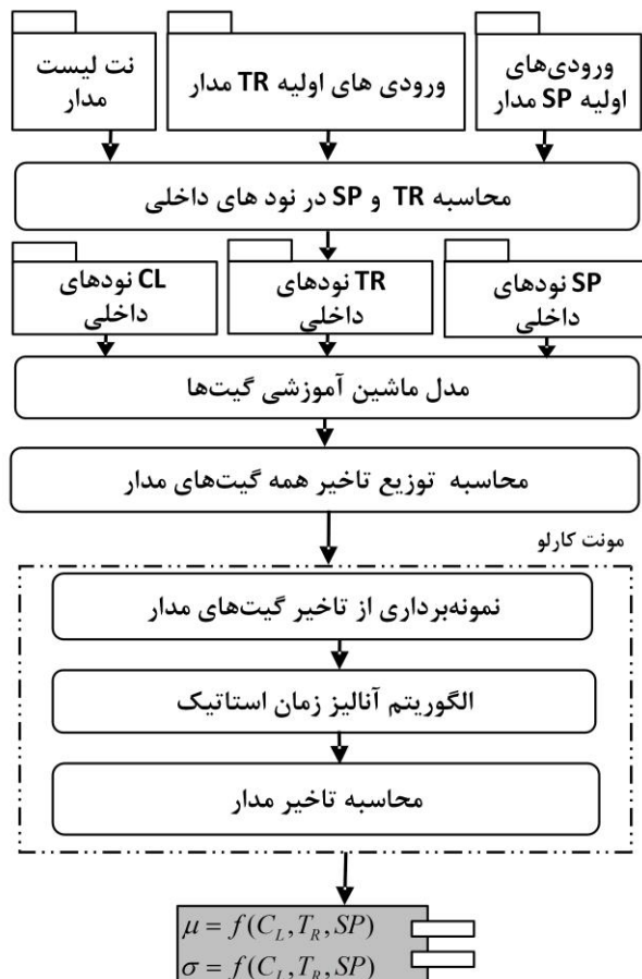
شکل (۴): فرایند محاسبه مدل تأخیر مدار دیجیتال
