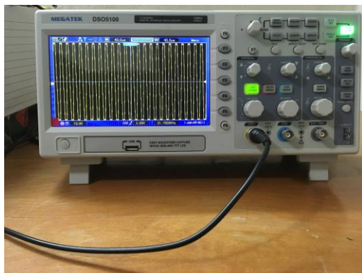
شکل (۱۱): نمونه‌ای از سیگنال خروجی (دو سر سیم پیچ القایی) تولید شده در اسیلوسکوپ
