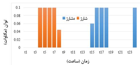
شکل (۱۹): شارژ و دشارژ باتری ها در طرح اول
