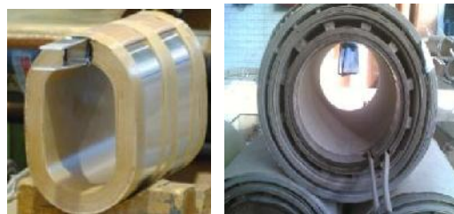
شکل (۱) مقطع ترانسفورماتور (الف) سیلندری، (ب) اوال
