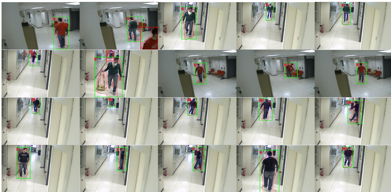
شکل (۱۷): نمونه‌ای از نتایج شناسایی و ردیابی افراد با روش‌های پیشنهادی در شبکه‌ای از دوربین‌ها
