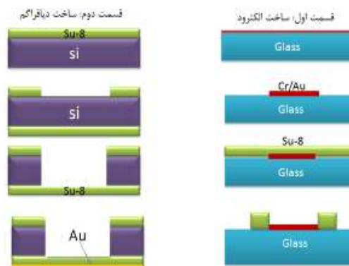
شکل (۹): مراحل ساخت
