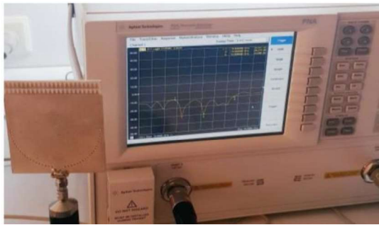
شکل (۱۵): نمونه آنتن ساخته شده به همراه نتایج اندازه‌گیری ضریب بازگشتی
