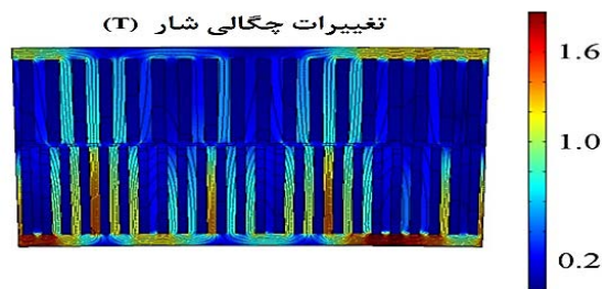
شکل (۱۷): تغییرات چگالی شار روتور قفل شده با q=1.5
