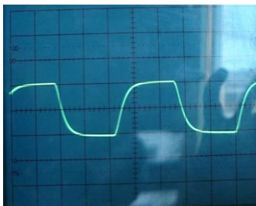
شکل (۱۴): سیگنال خروجی در فاصله ۵۰ سانتی متری با فرکانس تحریک ۵۰ کیلوهرتز
