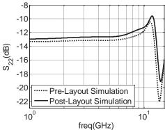
Fig. 27. Simulated output return loss(dB)
