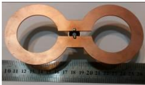
شکل (۱۰): نمونه ساخته شده از آنتن دوقطبی فوق پهن باند پیشنهاد شده
