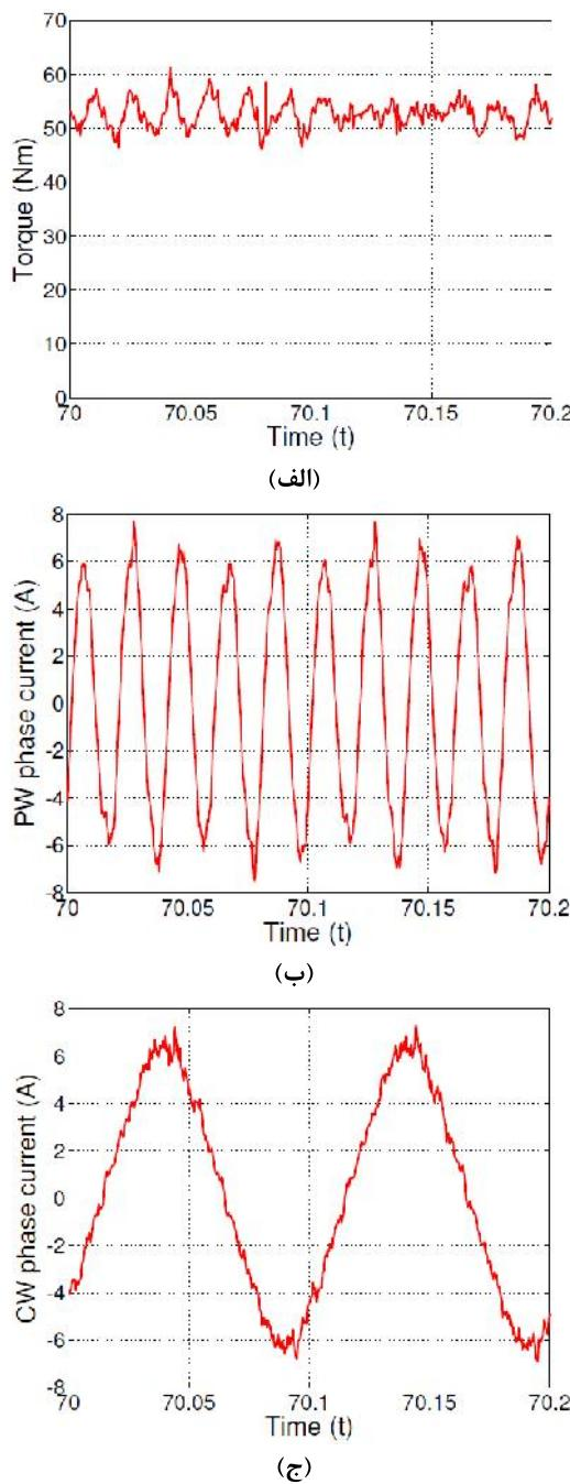
شکل (۴): نتایج اندازه‌گیری شده در سرعت مرجع ۶۰۰ rpm
