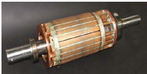
شکل (۲): رотор حلقه آشیانه‌ای [۸]
