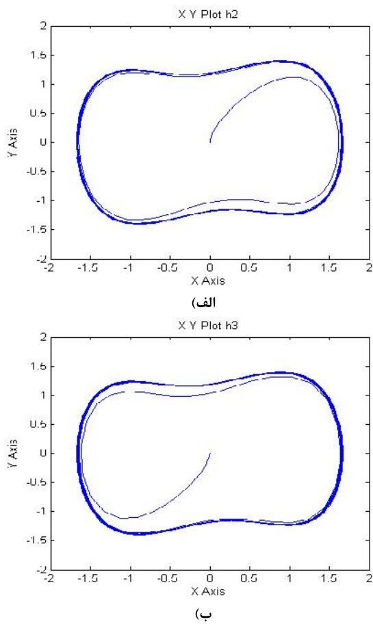
شکل (۵): خروجی اسیلاتور تحریک شده توسط (الف) هارمونیک دوم جریان دیفرانسیل (ب) هارمونیک سوم جریان دیفرانسیل
