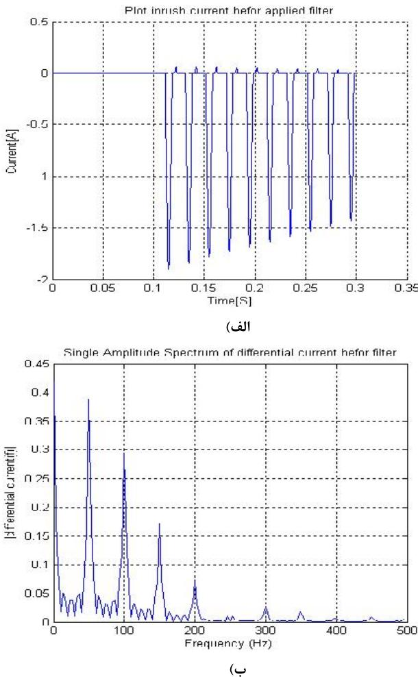
شکل (۴): (الف) شکل موج جریان تفاضلی در حالت اول شار پسماند و کلیدزنی با زاویه شروع ۳۶ درجه (ب) طیف فرکانسی
