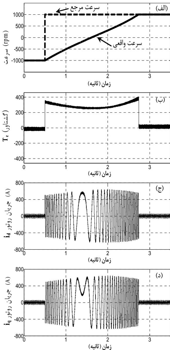
شکل (۶): نتایج شبیه سازی برای سرعت  $1000 \text{ rpm} \pm$  بدون جبران شار روتور، الف: پروفایل سرعت روتور، ب: پروفایل گشتاور تولیدی، ج: جریان روتور بر روی محور  $d$ ؛ د: جریان روتور بر روی محور  $q$
