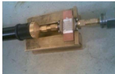
شکل (۱۳): روش پیشنهادی برای اندازه‌گیری پارامترهای سوئیچ
