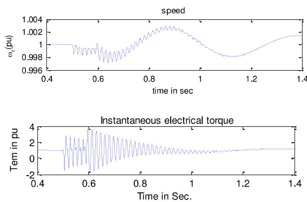
شکل (۱۵): سرعت و گشتاور لحظه‌ای موتور به دنبال وقوع فلش نوع C با  $s=0/5$  و طول مدت ۵/۵ سیکل.
