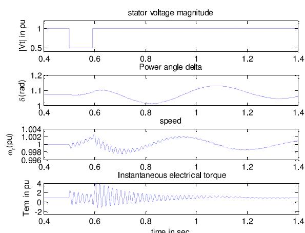
شکل (۸): ولتاژ مؤثر، زاویه بار، سرعت و گشتاور لحظه‌ای موتور به دنبال وقوع فلش نوع A با  $s=0/5$  و طول مدت ۵/۵ سیکل.
