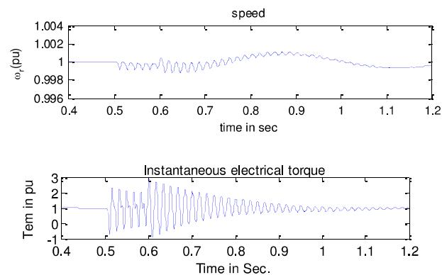
شکل(۱۱): سرعت و گشتاور لحظه‌ای موتور به دنبال وقوع فلش نوع B با  $s=0/5$  و طول مدت ۵/۵ سیکل.
