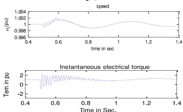
شکل (۷): سرعت و گشتاور لحظه‌ای موتور به دنبال وقوع فلش نوع A با  $s=0/5$  و طول مدت ۵ سیکل.
