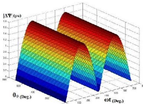
شکل (۳): تغییرات دامنه شار هنگام بازگشت دامنه ولتاژ به ازای تغییرات زاویه اولیه ولتاژ و طول مدت فلش برای فلش نوع A.
