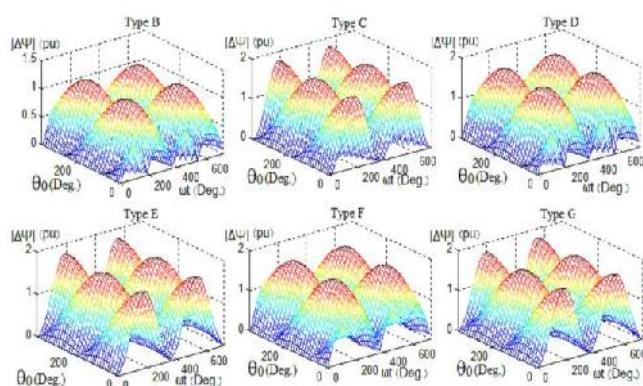
شکل (۵): نمودار سه بعدی حداکثر تغییرات شار در حین فلش، نسبت به تغییرات طول مدت فلش و نقطه آغاز آن روی موج ولتاژ با  $S=0/1$ .
