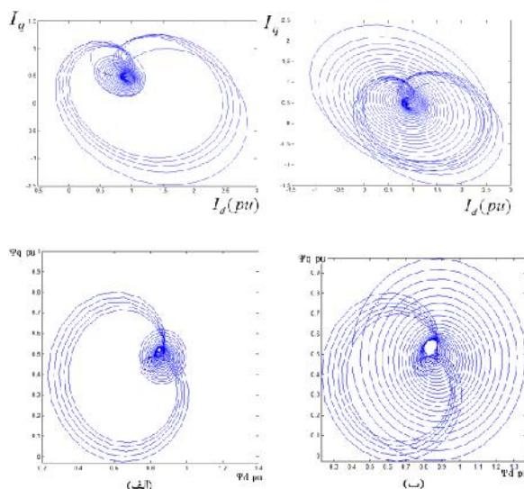
شکل (۹): مسیر شار استاتور و جریان استاتور در قاب سنکرون در حین و بعد از فلش نوع B با  $s=0/5$  و طول مدت (الف) ۵ و (ب) (ب) ۵ سیکل.
