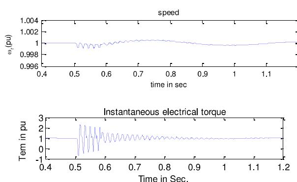
شکل (۱۰): گشتاور لحظه‌ای موتور به دنبال وقوع فلش نوع B با  $s=0/5$  و طول مدت ۵ سیکل.
