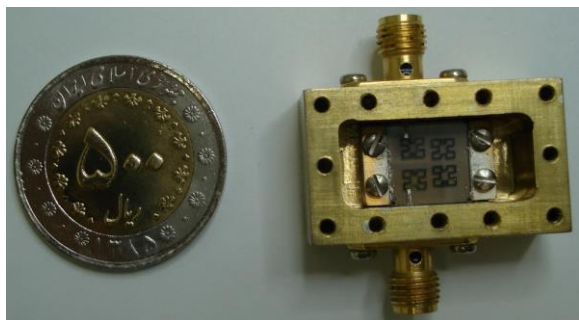
شکل (۸): تصویر فیلتر ابررسانا و جعبه آن
