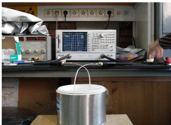
شکل (۹): سیستم اندازه گیری مشخصات فیلتر ابررسانا
