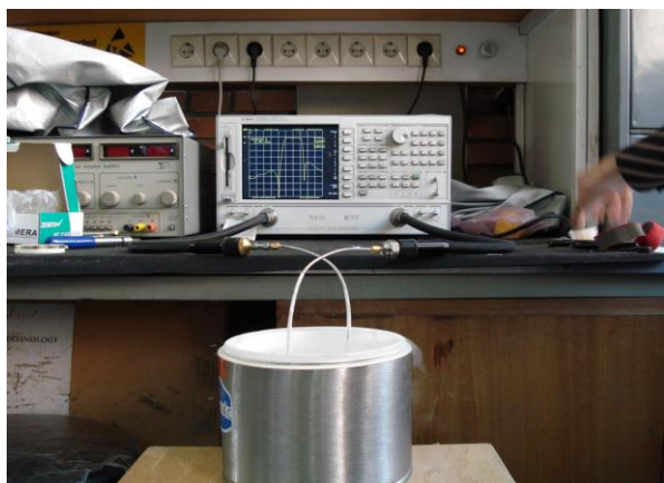
شکل (۹): سیستم اندازه گیری مشخصات فیلتر ابررسانا
